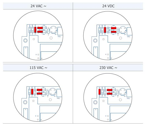
Die Ausgangsspannungen 115Vac oder 230Vac sind bei den Modellen mit 24Vdc-Eingang nicht verfügbar.
