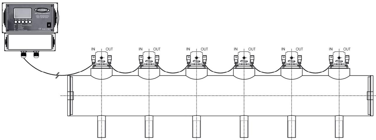
collegare le altre elettro valvole in sequenza utilizzando i cablaggi di collegamento con i connettori PG7 rispettando la polarità IN -> OUT, montare le guarnizioni per garantire la tenuta IP del circuito.
