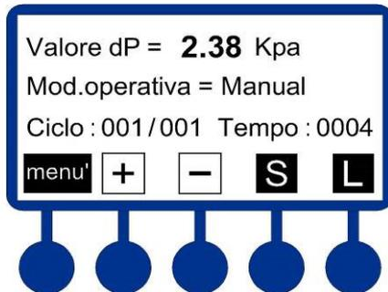
Le informazioni visualizzate sono: la modalità di funzionamento, la pressione interna del depolveratore, le uscite attive e il tempo necessario all'attivazione della prossima uscita.
