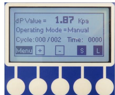
Sur l'écran principal, lorsqu'une alarme est active, la lettre **L** change d'État devient **A**, en appuyant sur   défiler les alarmes, en appuyant sur **A** revient à l'écran avec lecture dP.
