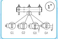
TUYAU DE SORTIE LISSE COURT = G1 TUYAU DE SORTIE LISSE LONG = G2 TUYAU DE SORTIE FILETÉ LONG = G3 TUYAU DE SORTIE FILETÉ COURT = G4
